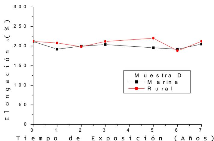
Fig. 8. Elongación relativa. Muestra D. Bajo techo.
