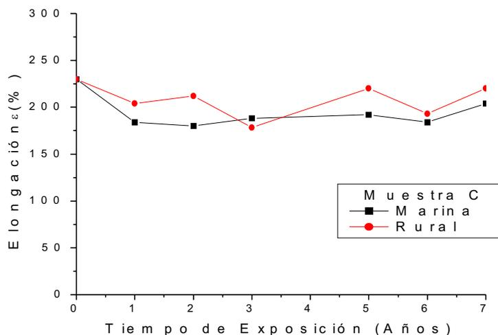
Fig. 7. Elongación relativa. Muestra C. Bajo techo.
