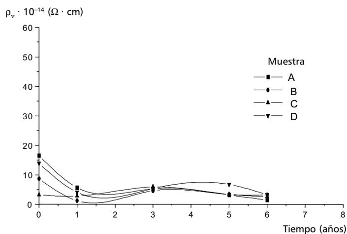
**Fig. 13.** Resistividad volumétrica. Estación marina. Bajo techo.
