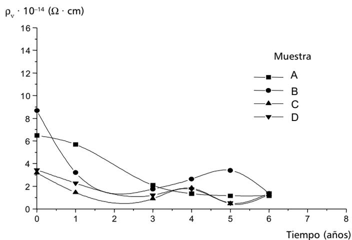
Fig. 10. Resistividad volumétrica. Estación marina. Intemperie.
