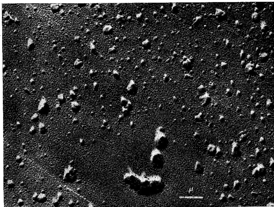
FIG. 6. Silicato entre cristales de  $\text{MgO}$ .
