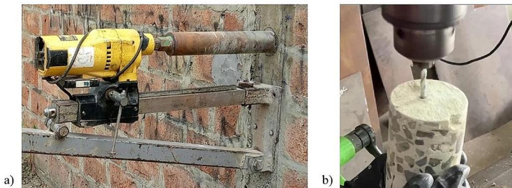
**Fig. 1.** Máquina usada en la extracción del testigo cilíndrico en la columna a). Extracción de las muestras de polvo en el taladro a diferentes profundidades.
