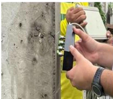
Fig. 2. Medición de la \rho en una en la columna de las estructuras seleccionadas.
