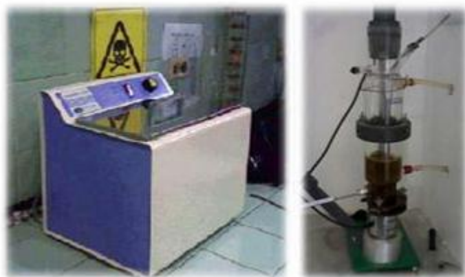
Fig. 1. Tipos de reactores ultrasónicos más utilizados para la extracción asistida por US a) Baño ultrasónico. b) Tipo Horn
